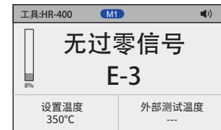
E-3: 无过零信号 处理措施: 过零传感器损坏或市电频率不对 传感器损坏建议返厂维修
