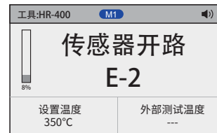
E-2: 传感器开路 处理措施: 建议返厂维修
