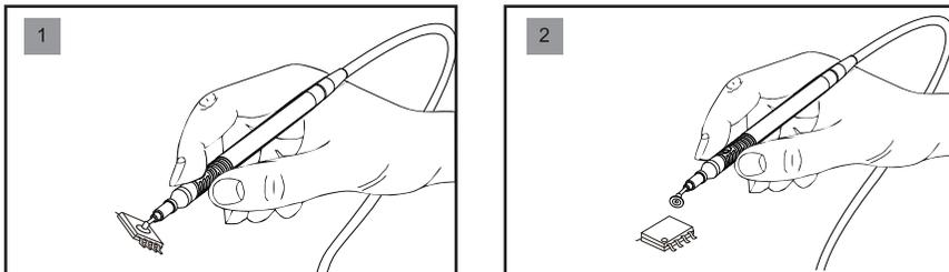
吸笔功能开启时, 用手指堵住吸笔吸气开关孔, 即可吸住贴片元器件。
