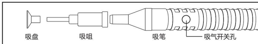
将吸咀的头部插入吸盘的孔处, 最后将吸笔插上吸咀的尾部, 完成吸笔组装。
