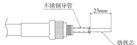
更换新烙铁芯时，应将烙铁芯伸出不锈钢导管23mm，再锁紧手柄内烙铁芯安装螺钉
